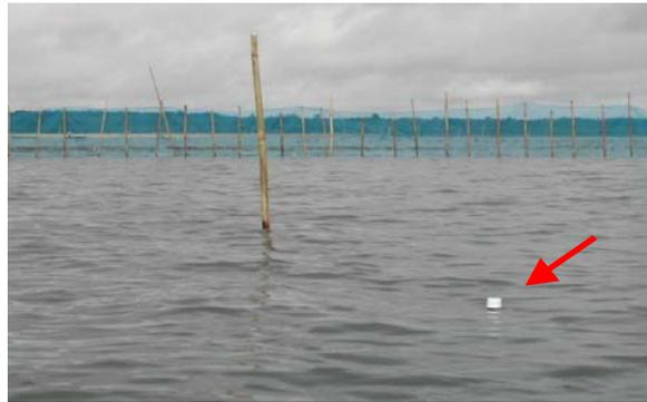
Figura 9 – Medição dos valores de velocidade de corrente utilizando uma garrafa plástica.
