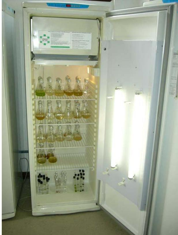
**Figura 1:** Câmara ambiente para germinação (modelo 347-CDG, Fanem) com os cultivos das espécies analisadas.
