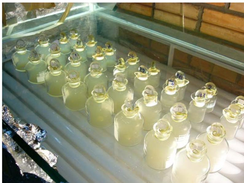
**Figura 2:** Aquário com as garrafas DBO dispostas em fila e iluminadas por uma lâmpada de halogênio.
