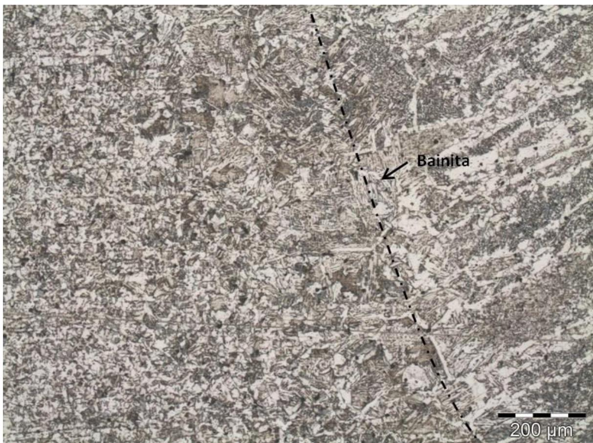
Figura 3: Microestrutura da linha de fusão de um aço ASTM A 131 GR EH36.
