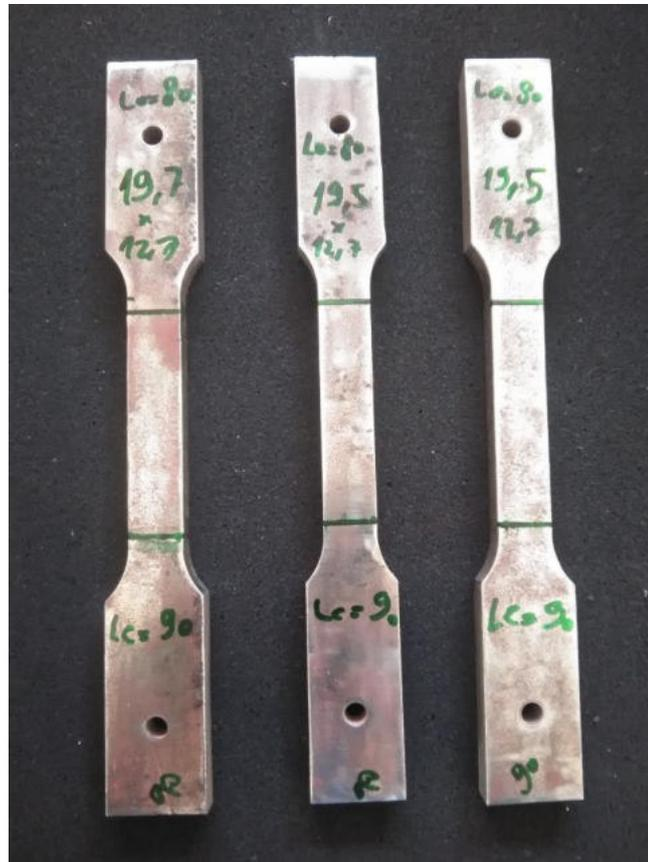
Figura 9: Corpos de prova para verificação das propriedades mecânicas
