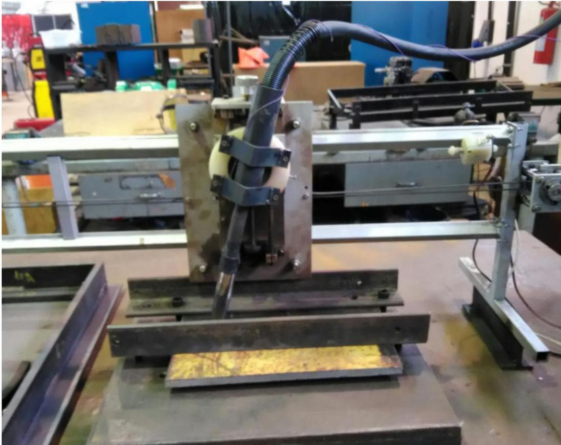
Figura 13: Dispositivo de deslocamento da tocha.
