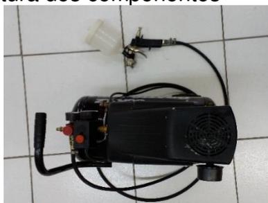
(a) Pistola de pulverização e compressor de ar comprimido
