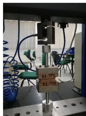
(b) Ensaio de tração perpendicular
