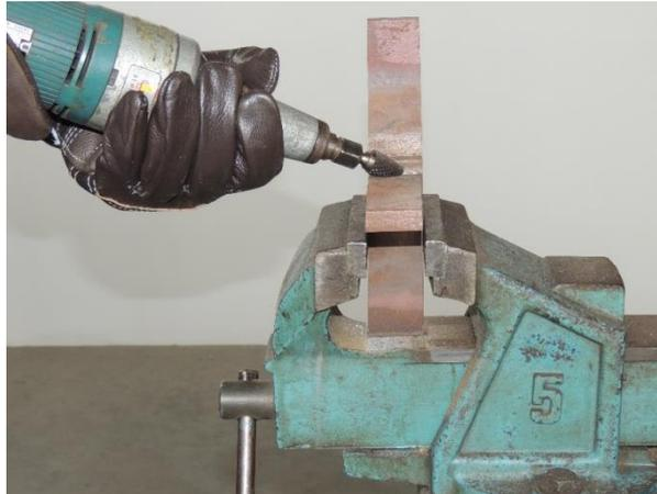
A Figura 42 mostra o processo de aferição, por meio de gabaritos, da profundidade e do raio do *toe grinding*. Já na Figura 43 pode ser observado o perfil obtido ao final do processo. A profundidade de ranhura resultante foi de aproximadamente 1 mm e o raio  $\sim 5$  mm.
