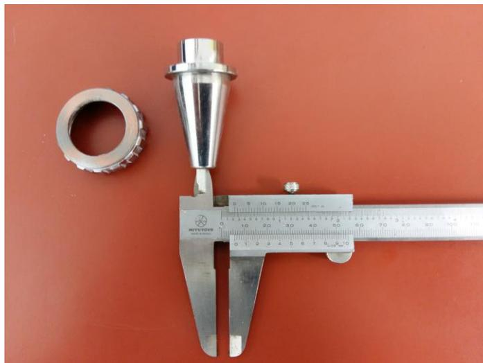
Figura 20 - Pistola utilizado no shot peening
