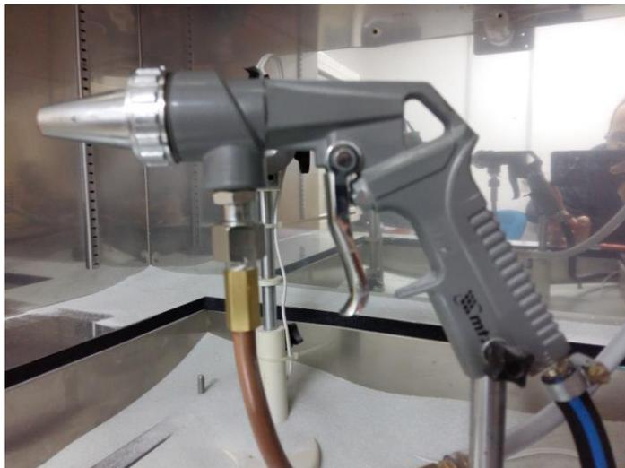
Na figura 21 abaixo, está a imagem do equipamento montado que foi realizado os processos de shot peening.
