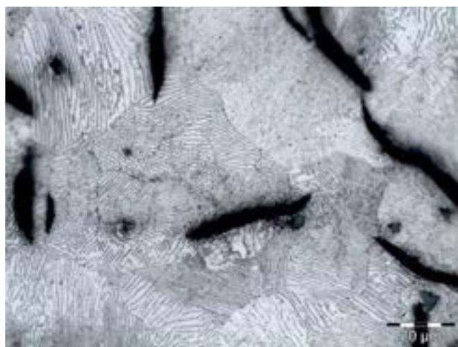
Figura 22 – Microestrutura das peças de FFC, após 5s de ataque
