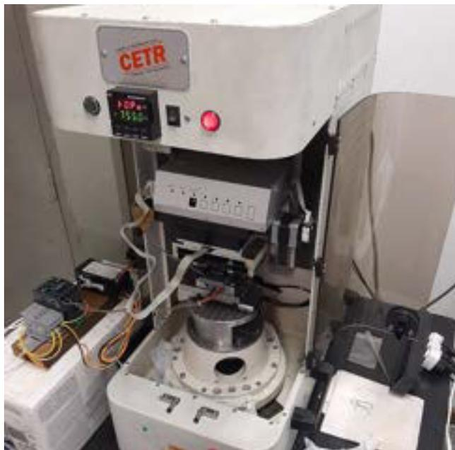
Figura 27 – Tribômetro CETR-UMT utilizado nos ensaios tribológicos
