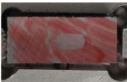
Figura 32 – Área de contato para a verificação de contato conforme entre o anel e a camisa
