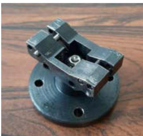
Figura 29 – Suporte para a fixação dos anéis
