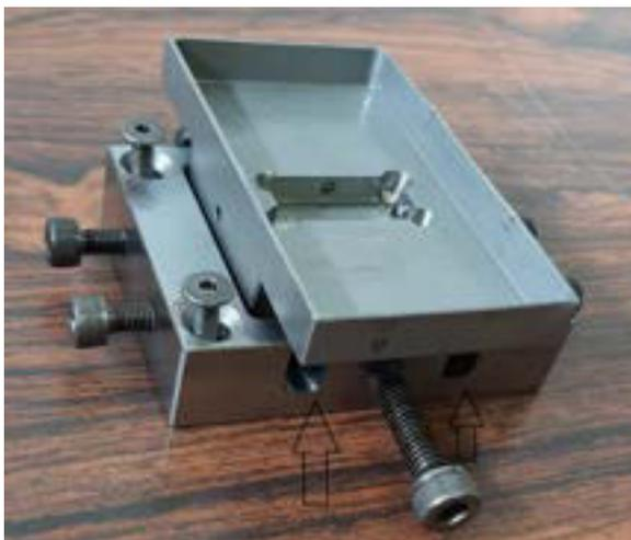
Figura 28 – Cuba para fixação das amostras e armazenamento de óleo lubrificante
