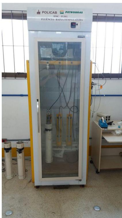
Figura 4.6 - Máquina de ensaio de fluência a altas temperaturas
