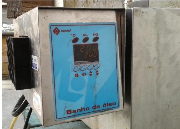
Figura 5 – Equipamento para o tratamento de termorreificação em banho de óleo.
