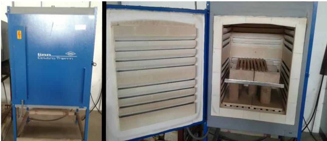
Figura 4 – Forno industrial utilizado para o processo de termorretificação simples.
