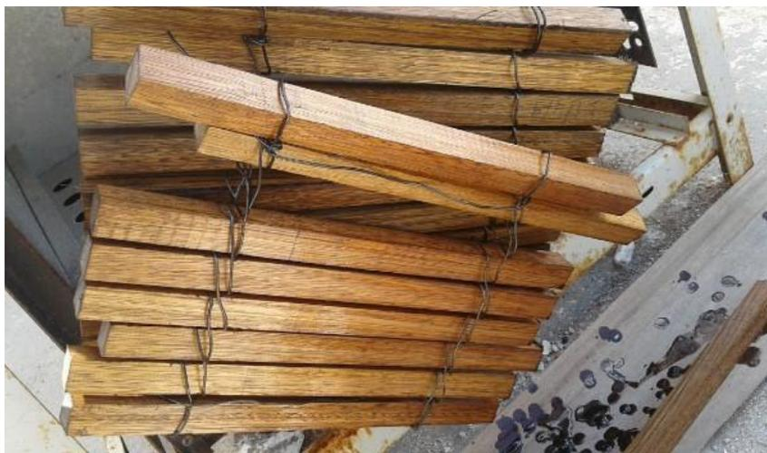
Figura 6 – Corpos de prova de *Eucalyptus* após tratamento de termorreificação em ambiente oleoso.
