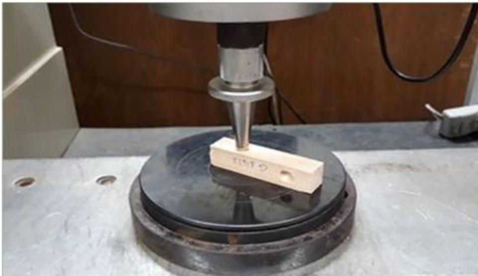
Figura 7 – Aparatos utilizados para a realização do ensaio de dureza Janka.
