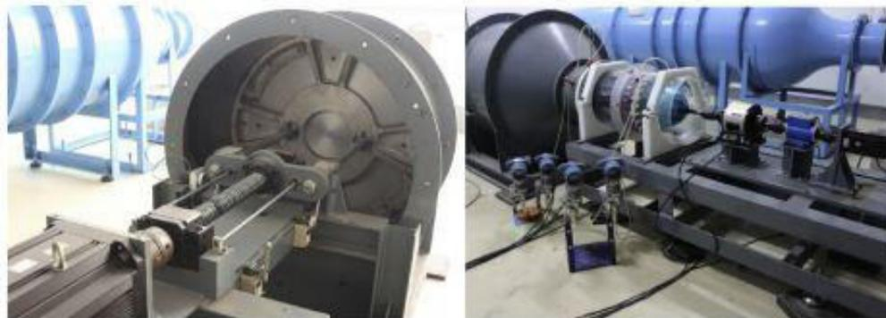
**Figura 1.7:** Instalação experimental para testes da turbina de impulso nos fluxos de ar alternativos. Fonte: Liu *et al.* (2019).
