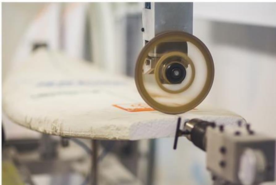
*Figura 1 Fresadora CNC operando com ferramenta do tipo disco*
