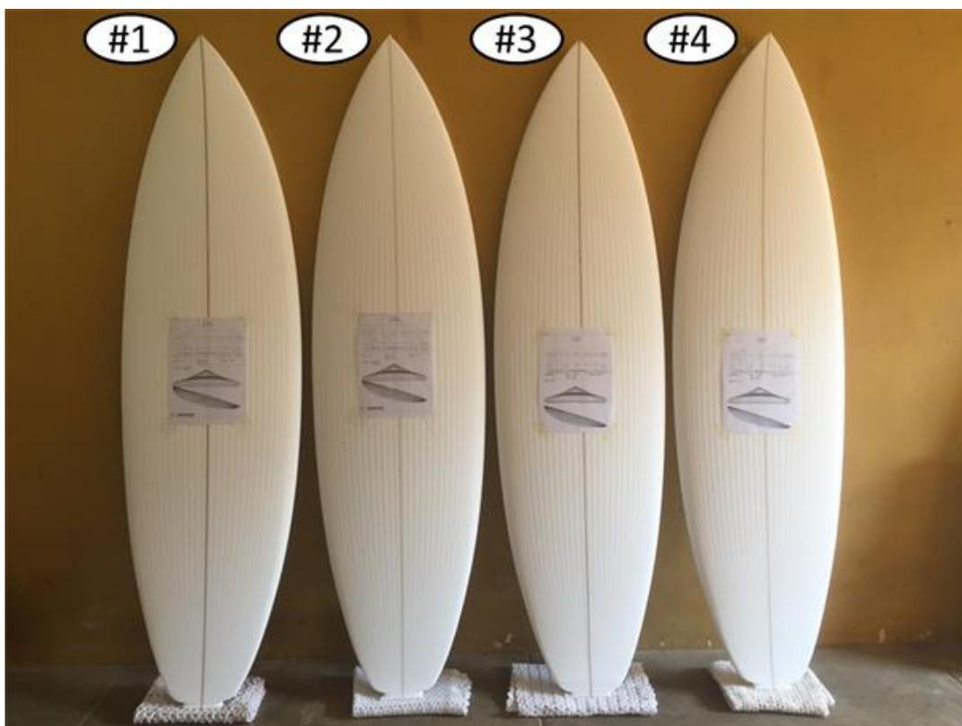
*Figura 18 Pranchas usinadas a partir dos blocos de EPS obtidos*
