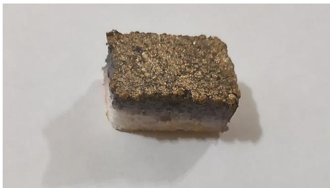
*Figura 14 Exemplo de uma amostra recoberta com ouro utilizada na análise de MEV e Confocal*
