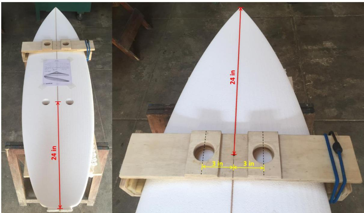
*Figura 13 Ferramenta utilizada como guia para extração das amostras*
