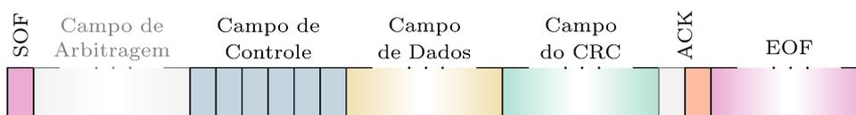
Figura 1.27: As regiões em destaque são monitoradas *bit a bit* pelo transmissor. O *bit* de ACK não é verificado pelo emissor, pois seu valor deve ser sobrescrito por um receptor. Fonte: Autores.
