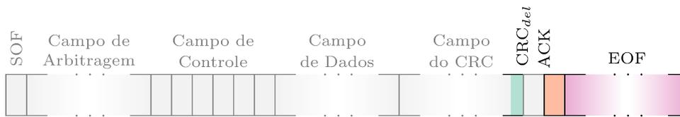
Figura 1.28: Representação dos *Bits* de formatação do *frame* CAN, todos eles devem ser recessivos e são os únicos usados na verificação de erro de forma. O *bit* de ACK não é usada na verificação de forma, mas seu delimitador sim. Fonte: Autores.
