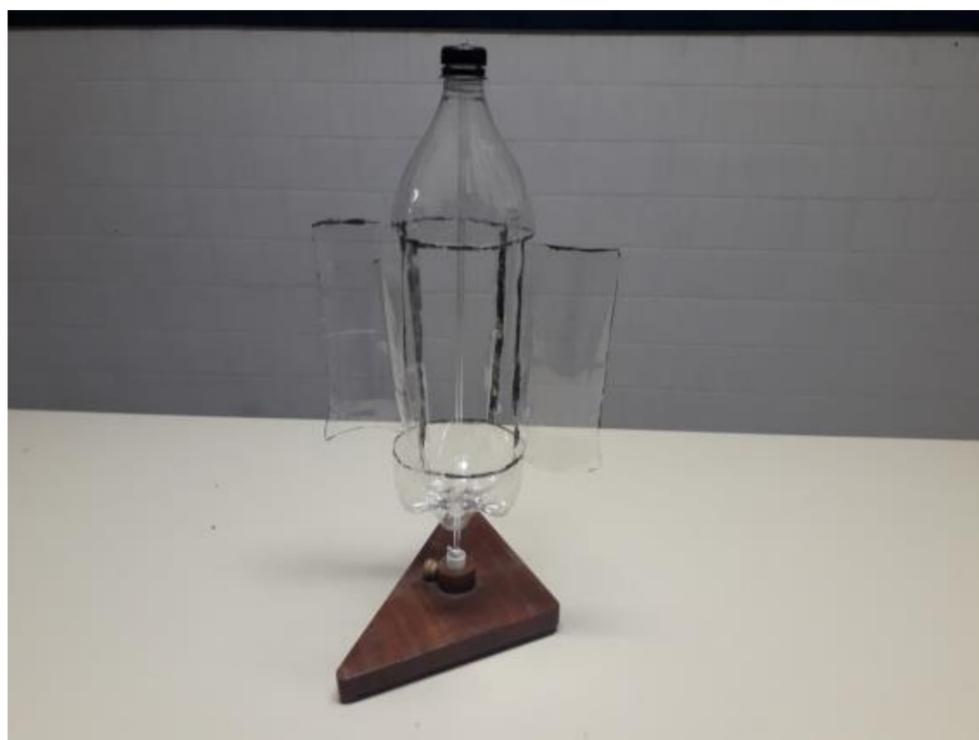
Figura 5.1: Montagem do anemômetro
