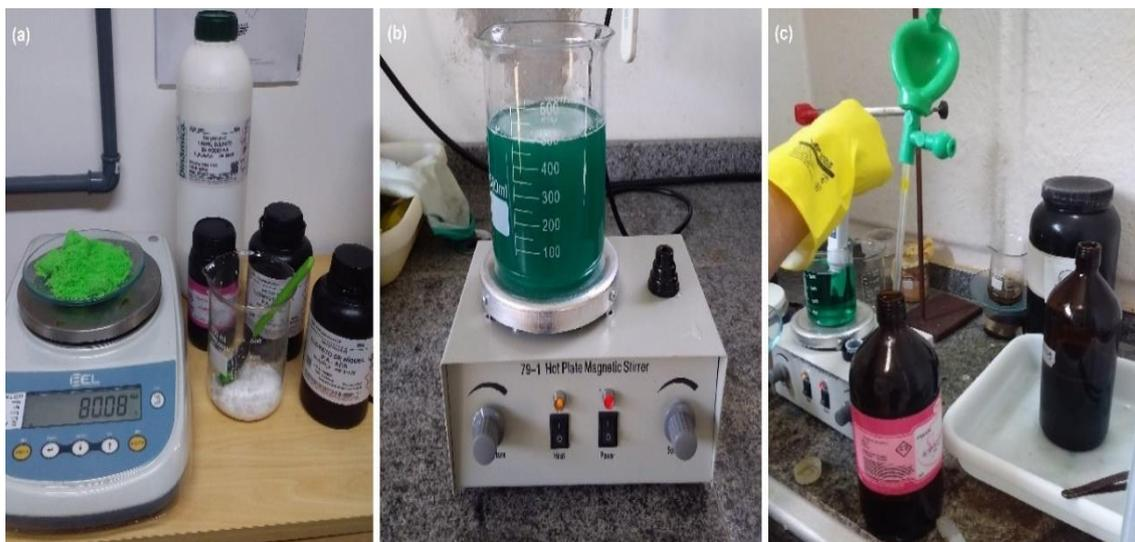
Figura 4.5. Etapas de preparação do banho eletrolítico: a) pesagem dos reagentes; b) agitação do banho; c) ajuste de pH com HCl.
