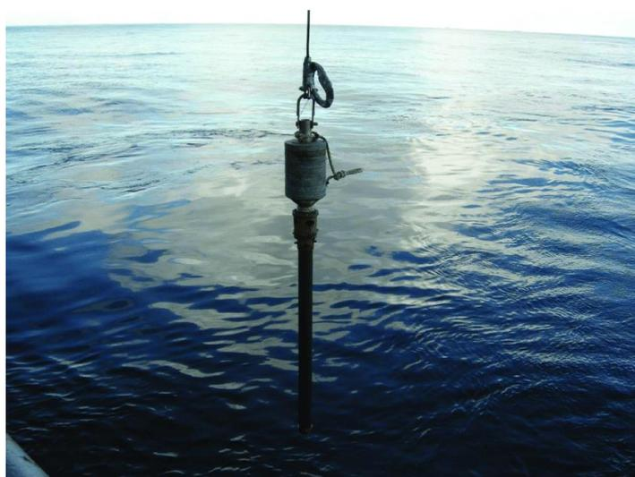
Figura 5-2 - *Gravity corer*. Fonte: Winsborow et al. (2012).
