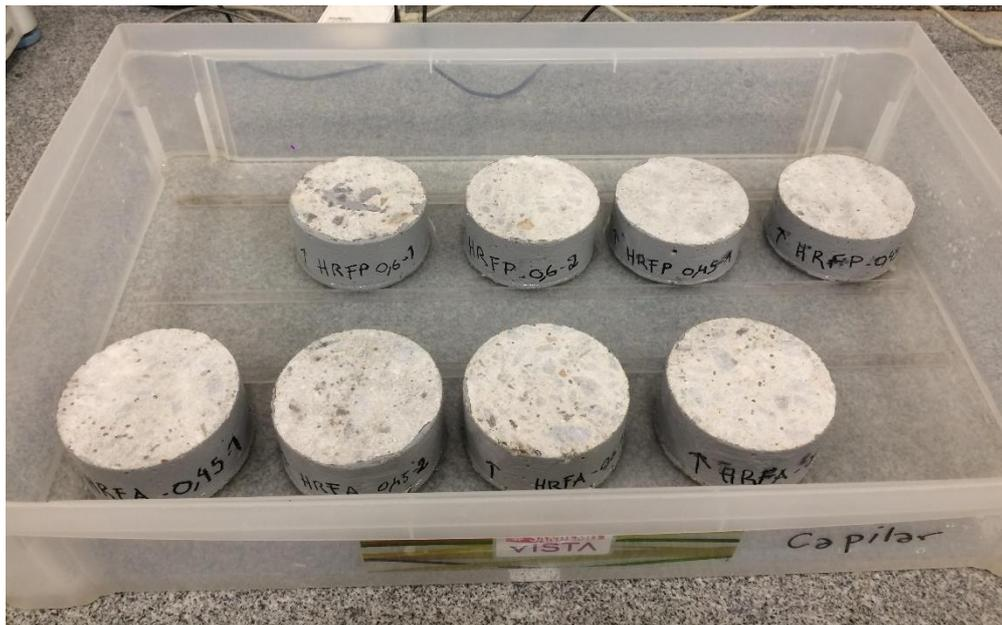
Figura 4.13 - Configuração do ensaio para determinar a capacidade e a velocidade de sucção capilar de água no concreto (corpos-de-prova das séries CRFA e CRFS)
