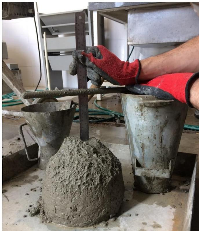
Figura 4.10 - Ensaio para determinar a consistência do concreto através do abatimento do tronco de cone (UNIT NM – 67: 1998)
