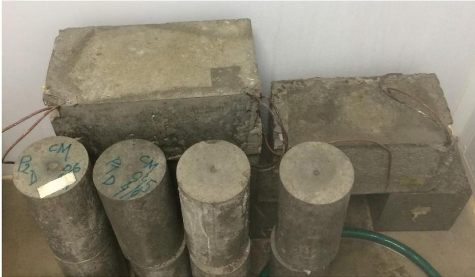
Figura 4.6 - Cura dos protótipos: cura em câmara úmida dos corpos-de-prova
