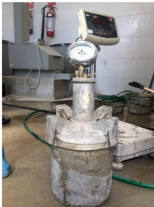
Figura 4.11 - Ensaio para determinação da quantidade de ar no concreto em seu estado fresco: (a) diagrama esquemático do medidor de pressão tipo B (UNIT-NM 47:2002); (b) realização do ensaio
