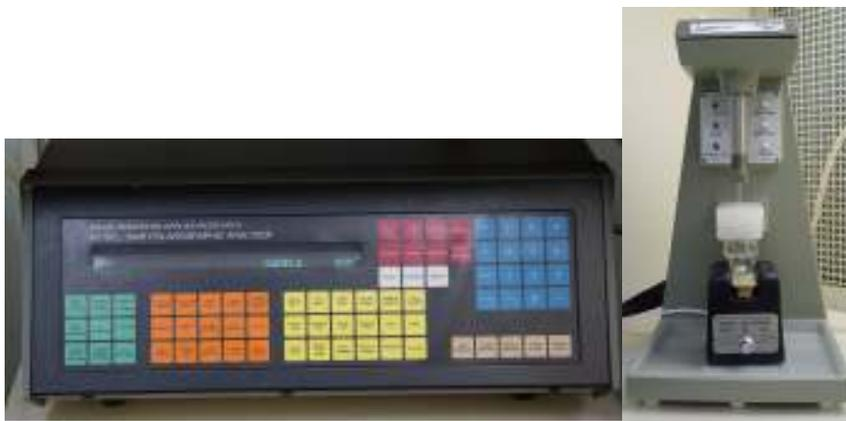
Figura 5.3 – Polarógrafo EG&G PARC Modelo 384B acoplado ao sistema de eletrodos 303A
