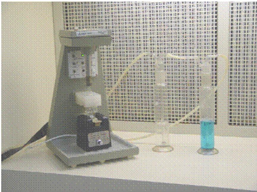
Figura 2.4 – Solução redutora de vanádio a ser renovada.
