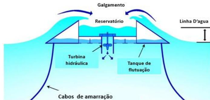
Figura 1.14 - Modelo experimental de um dispositivo de galgamento circular flutuante proposto por Liu et al. (2017b)
