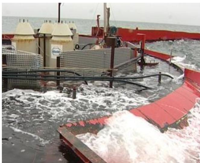
Figura 2.8 – Protótipo *Wave Dragon* em testes no mar (Extraída de <https://www.copybook.com/img/pgib4354s7214/wave-dragon-wave-energy-converter.jpg?v=1509463589>. Acesso em 21/05/2020).
