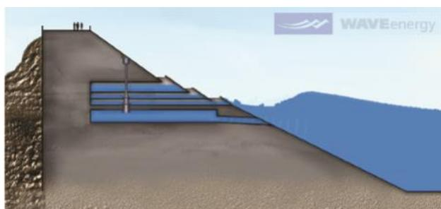
Figura 2.10 – Princípio de funcionamento do SSG (Extraída de <http://newinscience.blogspot.com/2008/04/sea-wave-slot-cone-generator.html>. Acesso em 21/05/2020).
