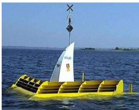
Figura 2.9 – Dispositivo *Wave Plane* (López et al., 2013).
