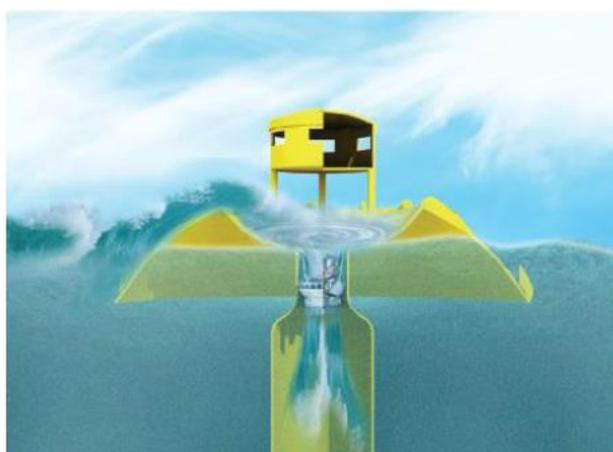
Figura 1.5 – Dispositivo de galgamento circular (Nam et al., 2008).
