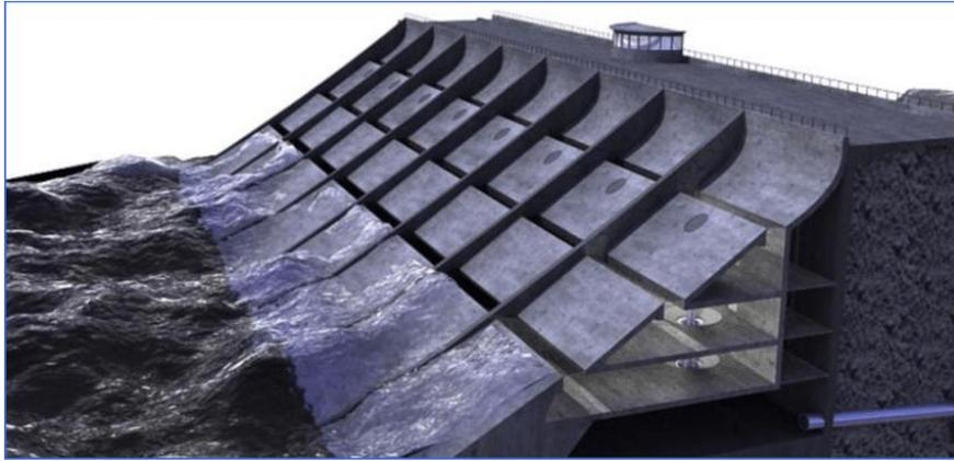
Figura 2.11 – Dispositivo *Seawave Slot-Cone Generator* (Vicinanza et al., 2012).
