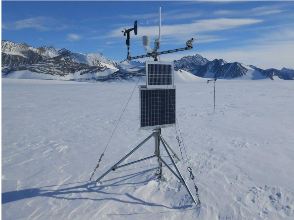
Figura 2.1 – Foto da estação meteorológica automática UNION13, instalada na Geleira Union próxima a base chilena EPCCGU, em 2013. Ao fundo, o sensor sônico SR50 para medição da altura da neve.
