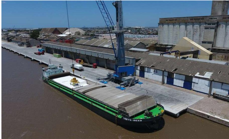
Figura 3.5 - Guindaste portuário durante uma operação de descarregamento de navio (Fonte: Próprio Autor).
