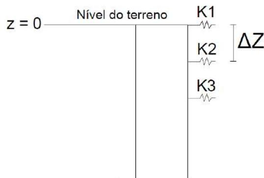
Figura 3.10 - Esquema de cálculo do coeficiente de rigidez de mola (Fonte: Wegmann, 2018)
