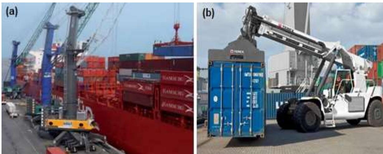
Figura 2.14 - (a) Exemplos de guindastes portuários, (b) Reach Stakers (Fontes: Catálogo da Liebherr e Catálogo Terex).
