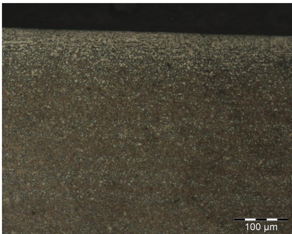
Na “zona escura” (no caso GMAW, localizada a uma distância entre 5,5 e 10 mm do centro da solda) não se verificou alteração de microestrutura com relação ao metal de base original. Tal fato indica que a linha mais externa da zona branca efetivamente representa a fronteira entre a região afetada e a não afetada pelo calor proveniente da soldagem. A estrutura, preponderantemente martensítica, porém, com pequenas ilhas de ferrita e perlita, é mostrada na Figura 30.
