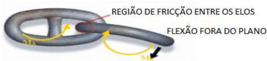
Figura 1.2. Região de fricção e flexão dos elos das amarras (Adaptado de Melis et al, 2005).
