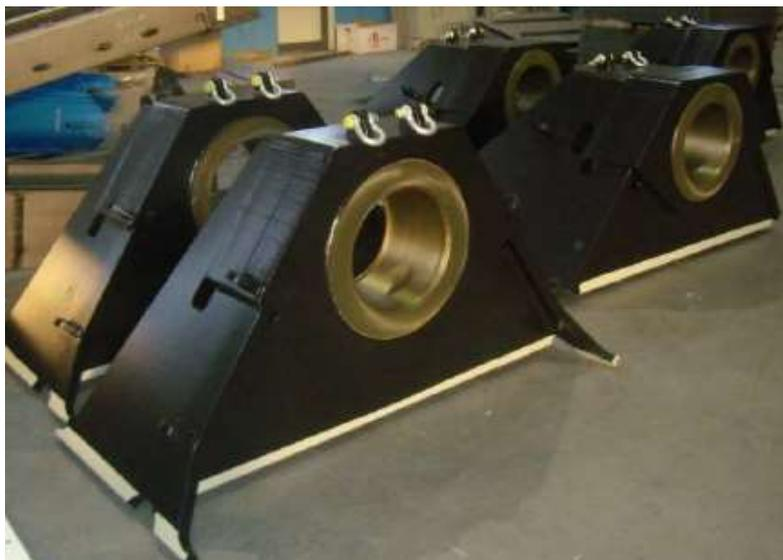
Figura 2.3. Conjuntos de *brackets* empregados nas plataformas P66 e P67 da Petrobras.
