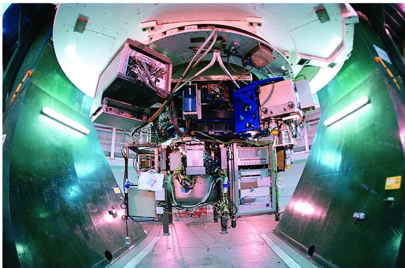
Figura 2.6: Liris, espectrográfo instalado no William Herschel Telescope, **Crédito:** imagem obtida em <http://www.ing.iac.es/PR/archive/wht/instruments4.html>. Acesso em 10/01/20019 as 13:35
