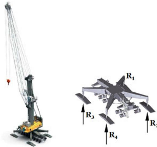
Figura 4.25. Modelo simplificado para cálculo das forças nas patolas dos guindastes móveis portuários (Adaptado de Liebherr).
