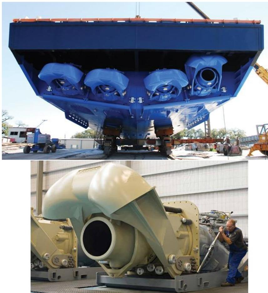
Figura 1.1 – Sistema de propulsão *waterjet* utilizados em embarcações da guarda costeira Coreana (Fonte: Hamilton Marine, 2019).
