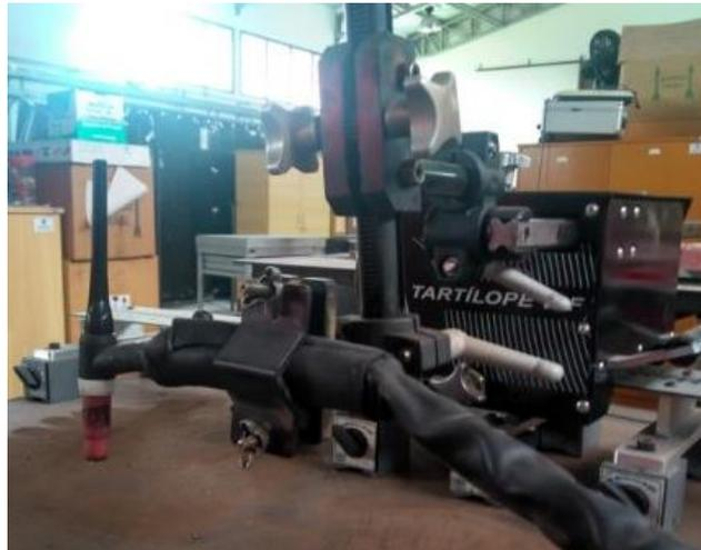
Tais pontos foram especificados de modo que o afastamento entre a ponta do eletrodo e o flanco do cordão ficasse entre 0,5 e 1,5 mm. Já o comprimento do arco (distância entre a ponta do eletrodo de tungstênio e a chapa base) inicialmente utilizado foi de 3 mm.
