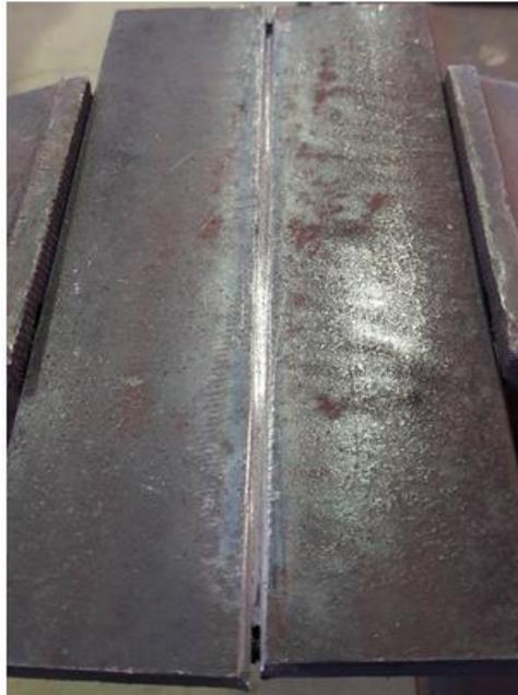
Com a finalização da soldagem do primeiro conjunto foi efetuada a verificação da integridade da junta no que concerne a descontinuidades externas e penetração do metal de solda.
