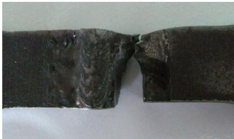
Figura 45 – Nucleação de trinca (figura 44).
