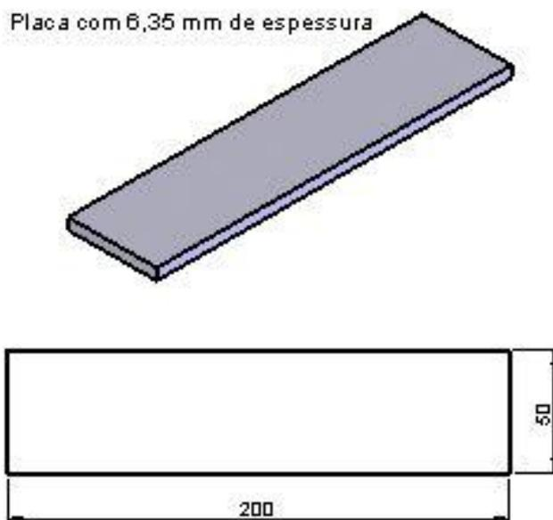
As placas a serem soldadas para posterior confecção dos corpos de prova apresentavam as dimensões mostradas na Figura 17.
