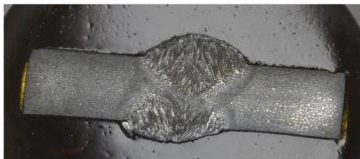
Figura 39 – Geometria da junta após refusão TIG.
