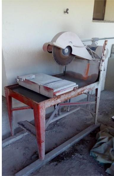
Figura 4.1- Serra circular resfriada por água utilizada na confecção das amostras. (Fonte: Autor)
