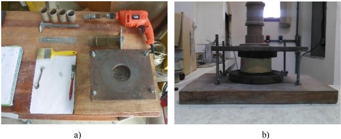
Figura 4.7- a) materiais e ferramentas utilizados; b) equipamento de fixação das amostras para extração. (Fonte: Bandeira, 2014)
