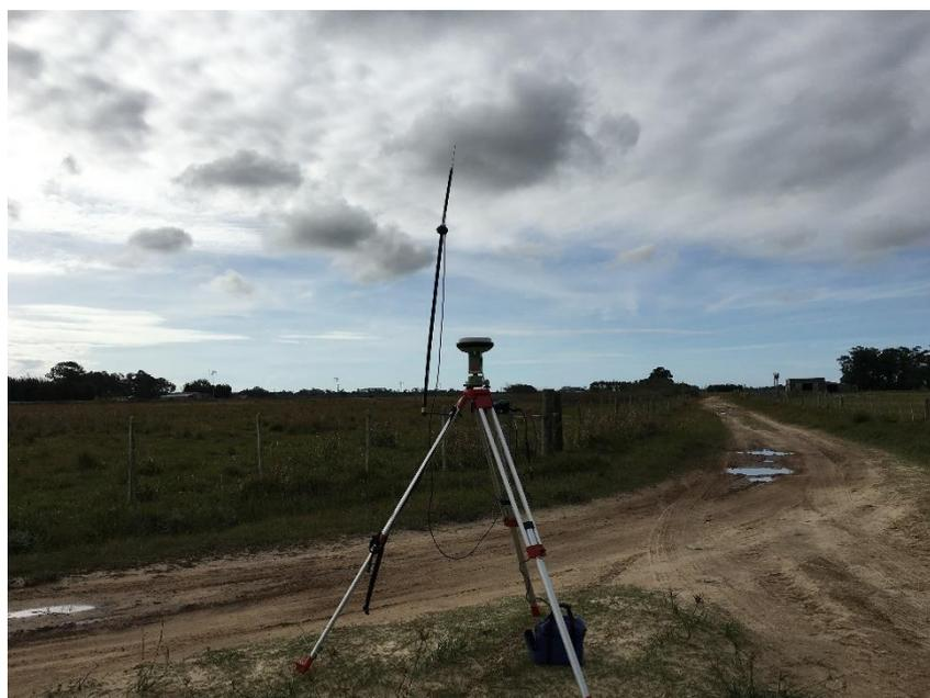
Figura 4.2.2 – Base fixa do GPS Geodésico utilizada no levantamento.
