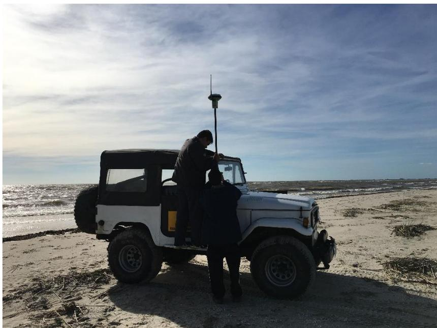
Figura 4.2.1 – Antena acoplada na lateral do carro usado para o serviço.
