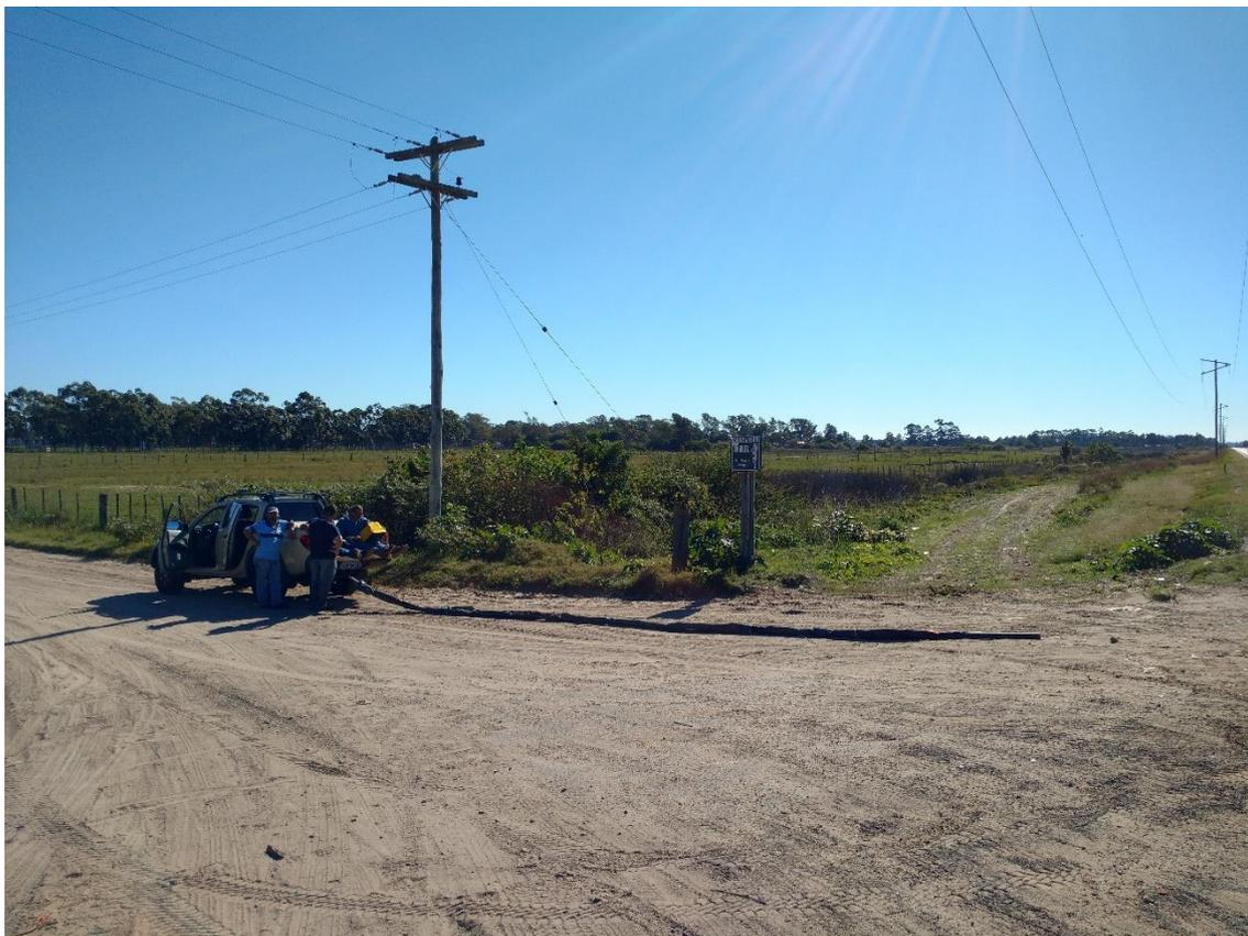
Figura 4.1.4 – Antena todo terreno (RTA) não blindada, tipo *snake*, de 50 MHz do GPR MALA-RAMAC utilizado no trabalho de campo. Equipamento da empresa HIDROSERV – Hidrogeologia e Geofísica Ltda.
