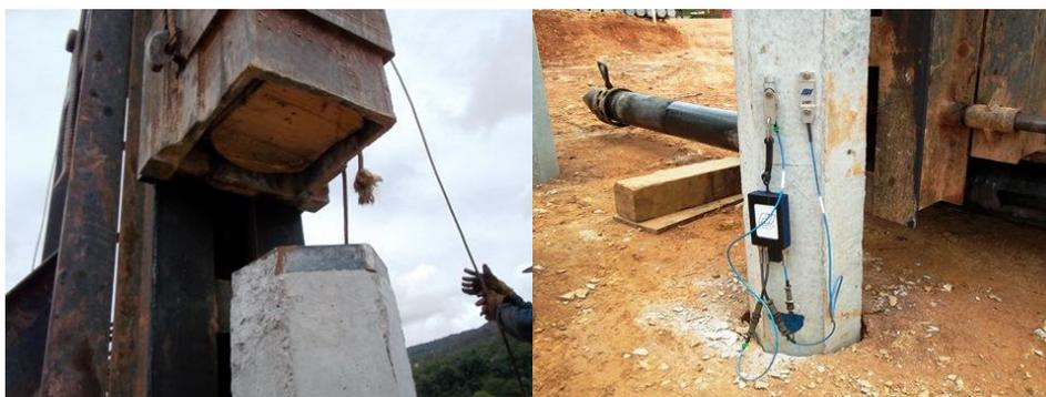
Figura 2.7 – Equipamento para operação de um ensaio dinâmico: a) Operação com martelo; e b) Equipamento PDA, transdutores na estaca (Moretti Engenharia, 2011).
