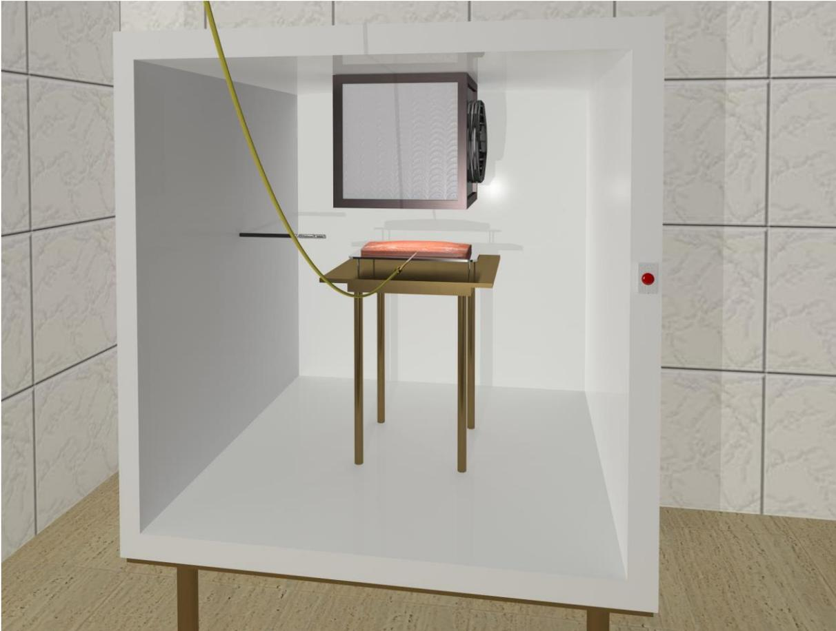
Essa câmara fria é formada por isopainéis de EPS, apresentando um volume interno de 729 L. O sistema de refrigeração utilizado é composto de uma unidade condensadora da empresa Elgin modelo TUM - 2053-E, evaporador da empresa Mipal modelo MMI015AHI e válvula de expansão termostática da empresa Danfoss modelo TX2-0.3. O fluido refrigerante utilizado pelo sistema de refrigeração foi o R-22 (monoclorodifluometano).
