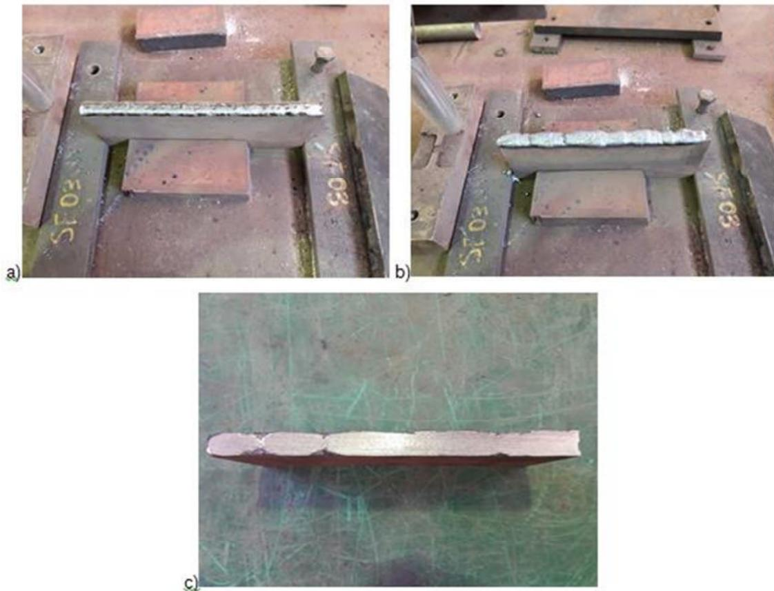
**Figura 35 – Etapas do processo de soldagem do chanfro reto na soldagem da junta: a) 1° Camada b) 2° Camada e c) Chanfro usinado pronto para a soldagem**
