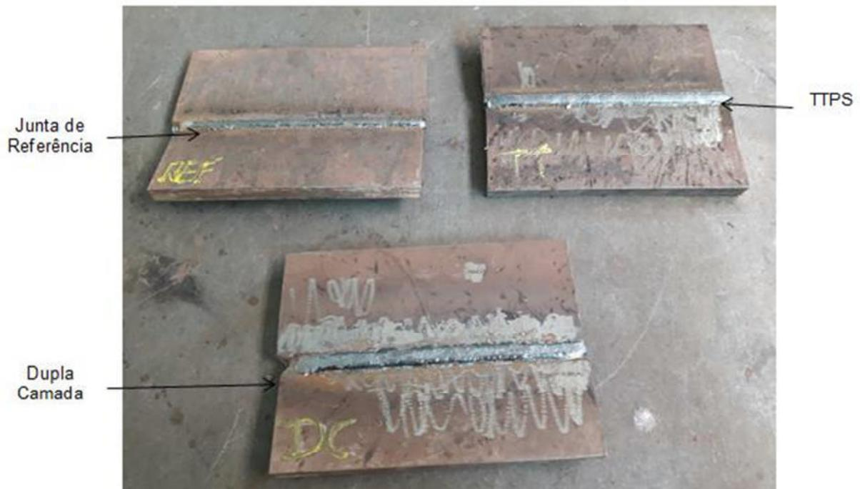
**Figura 37 – Corpos de prova soldados**
