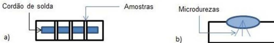
**Figura 13 – Retirada das amostras: a) Transversal ao corpo de prova; b) Detalhe das amostras com as linhas de direção para medição de microdureza**
