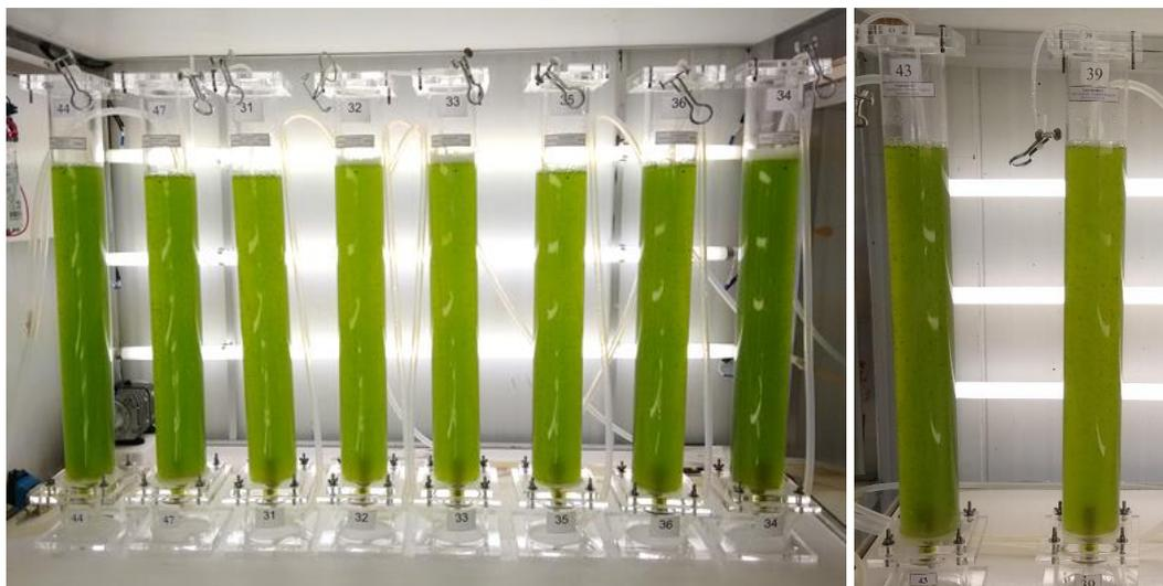
**Figura A3** – Cultivos para seleção da concentração de cloreto de sódio em fotobiorreatores *Erlenmeyers* na condição controle, com adição de 100, 200 mmol L<sup>-1</sup> de NaCl (a), 300, 400, 500 e 600 mmol L<sup>-1</sup> de NaCl (b)
