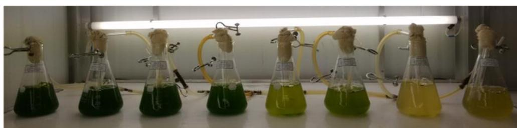
**Figura A4** – Cultivo em único estágio (UE) em fotobiorreatores tubulares verticais, ensaio controle e com adição 100 e 200 mmol L<sup>-1</sup> de cloreto de sódio
