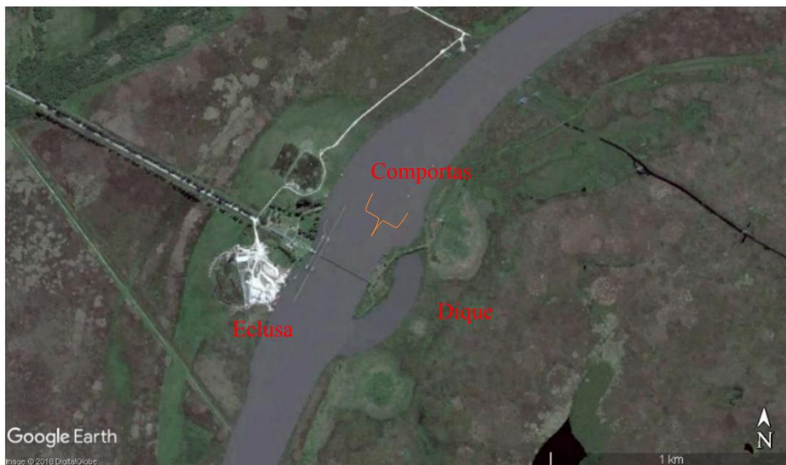
Figura 1.2 - Imagem da barragem eclusa, localizada no canal São Gonçalo. Na porção esquerda está situada a eclusa. Na parte central, localizam-se as 18 comportas basculantes, enquanto que na porção direita, encontra-se o dique (Fonte: Modificado de Google Earth, DigitalGlobe).
