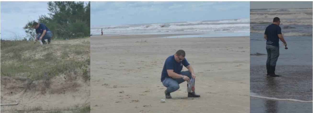
Figura 1. Processo de coleta de sedimentos em campo, à esquerda coleta sobre a crista da duna frontal, ao centro na praia subaérea e à direita na face da praia.
