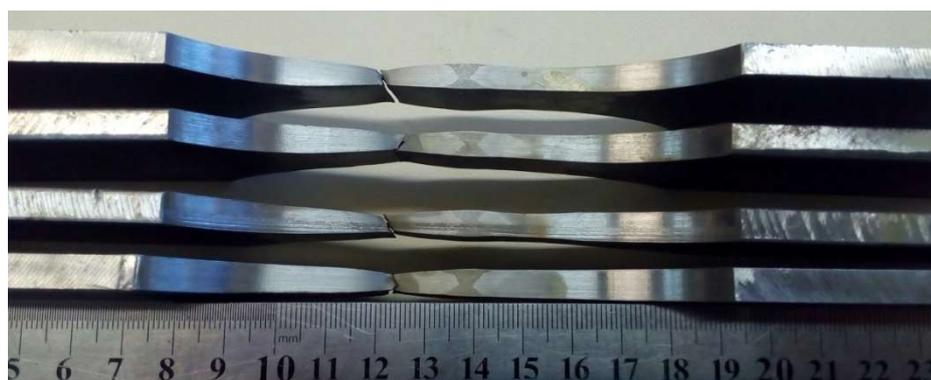
Foram realizados dois ensaios de tração para cada processo de soldagem, todos no sentido paralelo ao sentido de laminação e transversal ao cordão de solda. A tabela 17 mostra os resultados dos ensaios.
