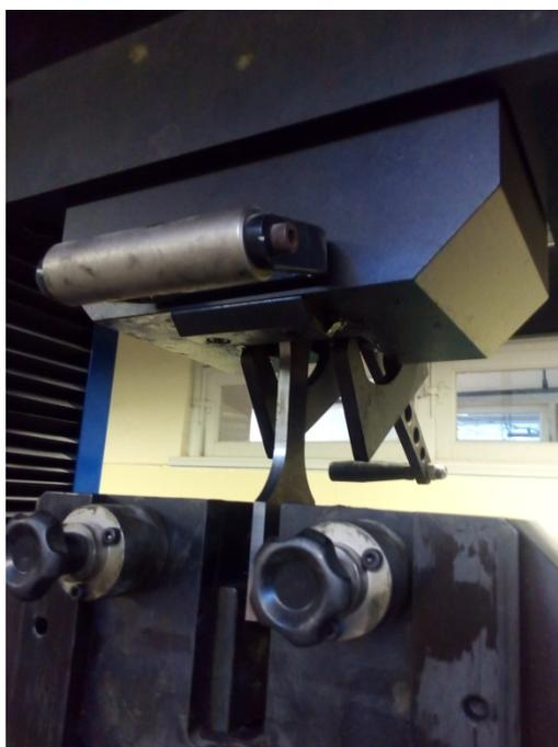
Figura 20 - Corpo de prova Rompido
