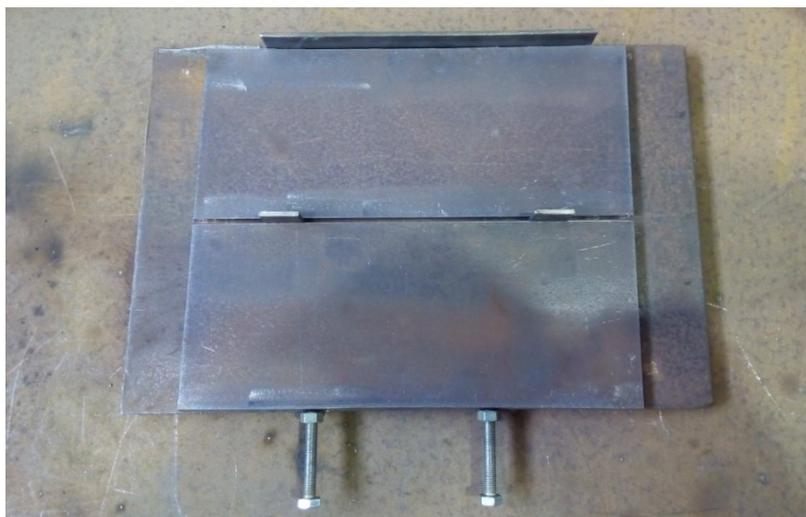
As chapas assim preparadas foram então fixadas a outro dispositivo, mostrado na figura 24, que restringe empenamentos e facilita o alinhamento da junta em relação à tocha.
