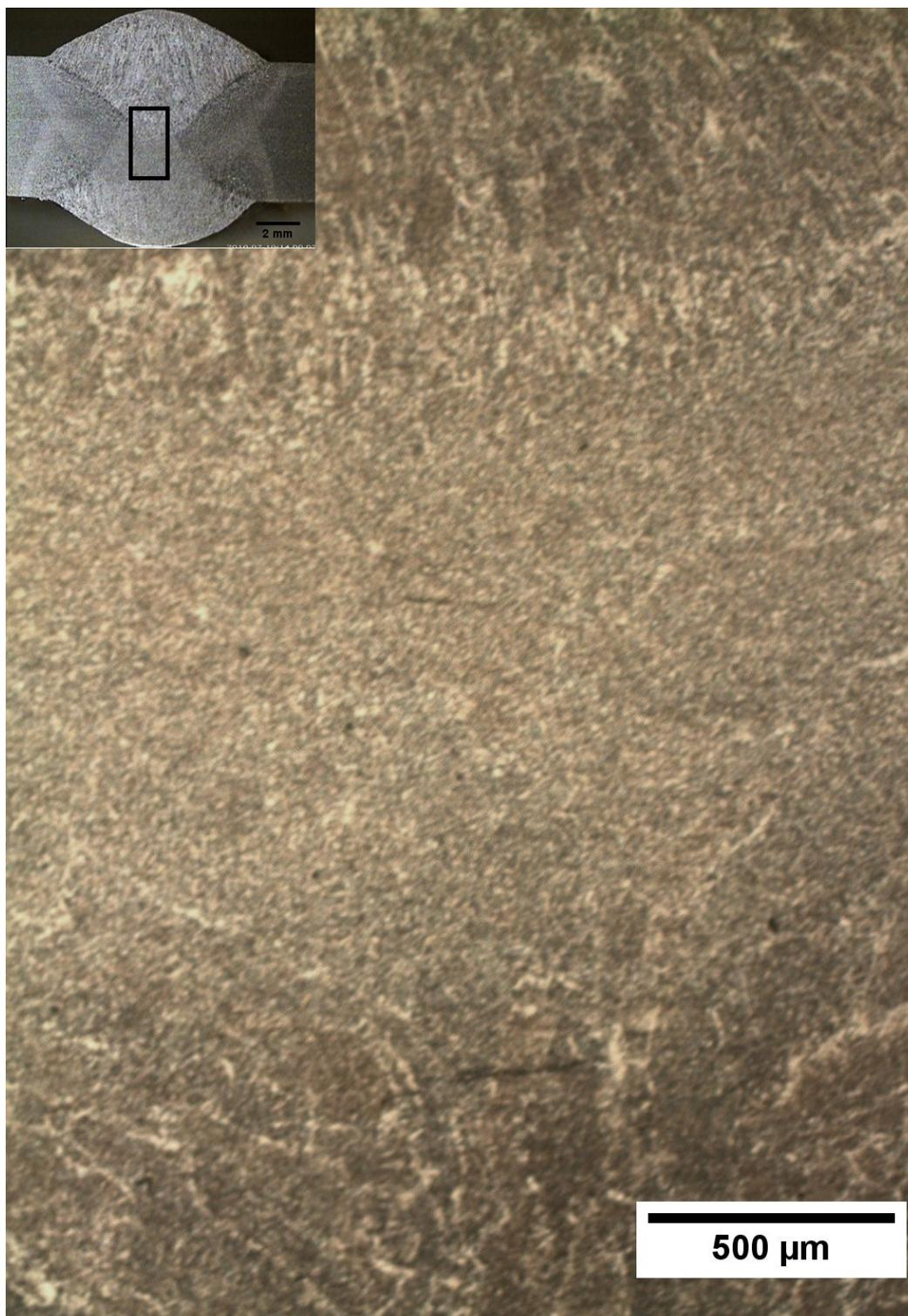
Figura 55 - Metal de solda alterado FCAW.
