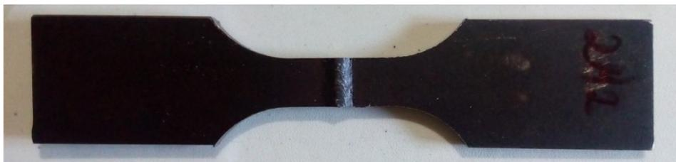
Conforme mencionado no objetivo do trabalho, havia um grupo de corpos de prova cujos reforços do cordão deviam ser retirados. Esse processo foi efetuado com máquina manual, visando obter um resultado semelhante ao que seria obtido em campo por um operador. Portanto, os reforços dos cordões foram retirados por meio de discos de desbaste e de acabamento. A figura 36 mostra a face de um corpo de prova depois de concluída essa etapa.
