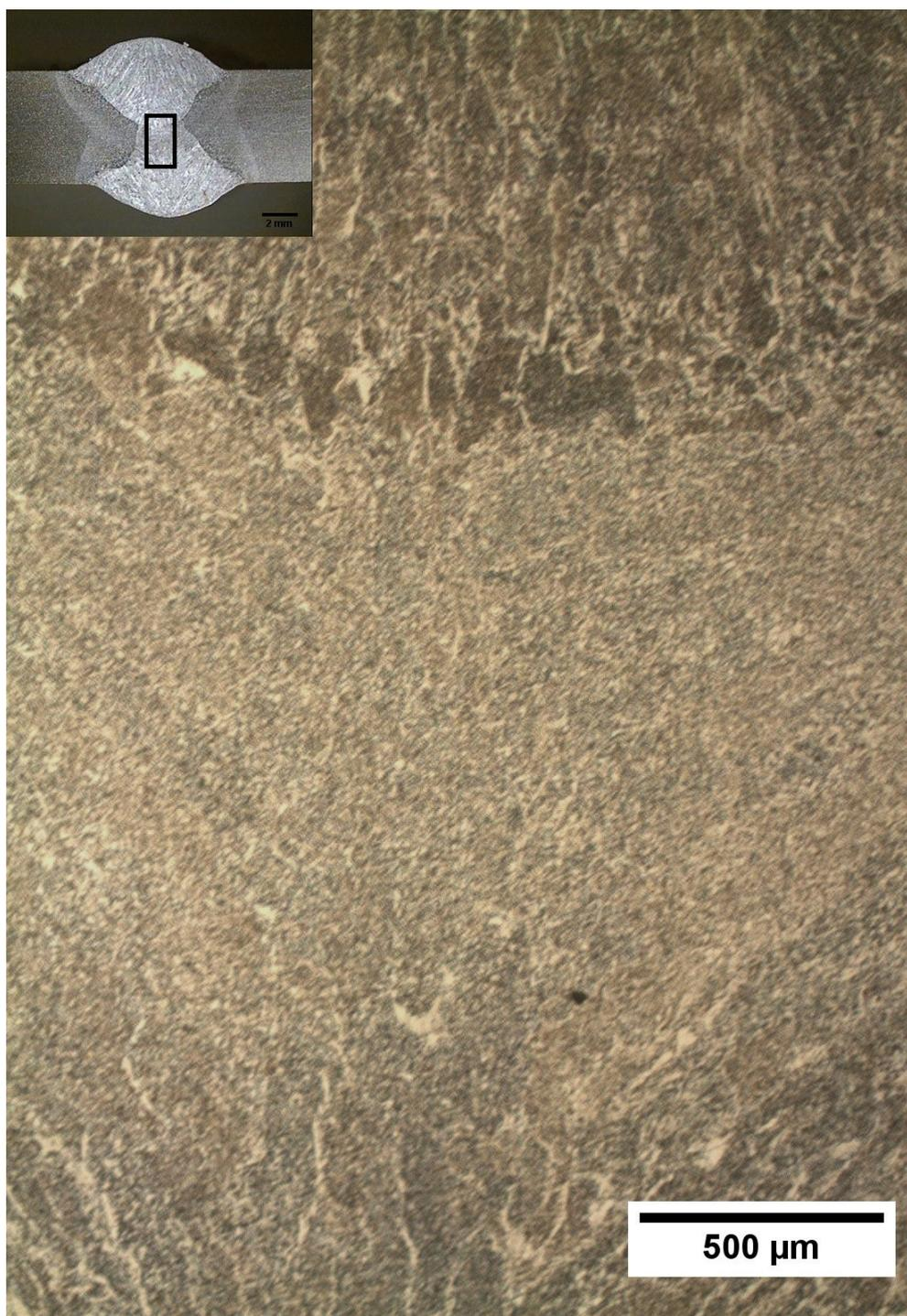
Análises microestruturais complementares da região compreendida pelo metal de solda (MS), zona afetada pelo calor no primeiro passe (ZAC-1), zona afetada pelo calor no segundo passe (ZAC-2) e zona afetada pelo calor entre passes (ZAC-EP) são ilustradas respectivamente nas figuras 56, 57 e 58.
