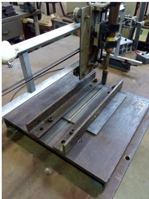
A goivagem da raiz foi efetuada conforme procedimento, equipamentos, parâmetros e consumíveis citados na seção 3.2. Após essa tarefa, as placas foram novamente fixadas ao dispositivo de sujeição para realização do segundo passe.
