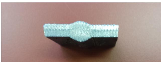
Para o processo FCAW, o arame utilizado foi da classe AWS A.5.20/ASME SFA 5.20 E71T-1C com diâmetro de 1,2 mm. O gás de proteção, os equipamentos e os acessórios foram os mesmos usados no processo GMAW, porém, houve necessidade de substituição da polia lisa de tracionamento de arame por uma recartilhada. A goivagem foi realizada de forma semelhante ao processo GMAW. As tabelas 6 e 7 mostram os resultados obtidos.
