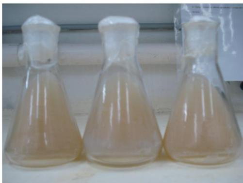
A propagação dos inóculos foi realizada em frascos Erlenmeyers contendo ágar nutriente (Figura 1), formulado conforme a seguir ( $\text{g L}^{-1}$ ): extrato de carne (1,0); extrato de levedura (2,0); peptona (5,0); NaCl (5,0). As culturas foram incubadas por 48 h a 30 °C. Após, foi realizada a raspagem da superfície do ágar com meio nutriente e ao atingir a
