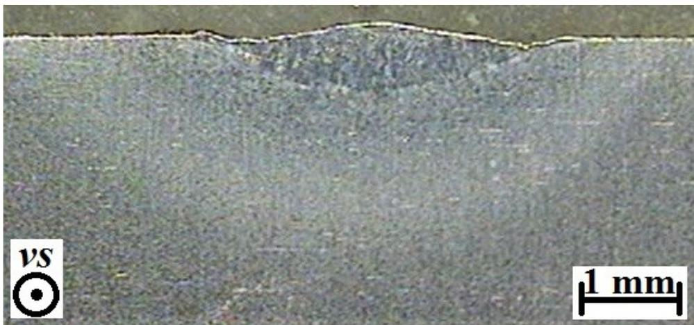
Figura 71 – Zona de fusão - 6 mm de espessura com inclinação da tocha
