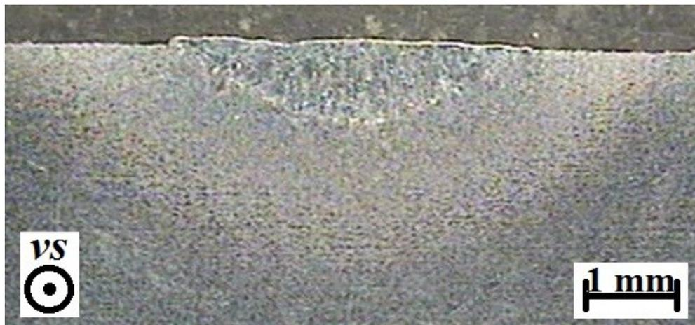
Figura 70 – Zona de fusão - 6 mm de espessura com deflexão magnética
