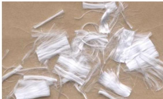
Figura 2.8: Fibras sintéticas de polipropileno para uso no concreto
