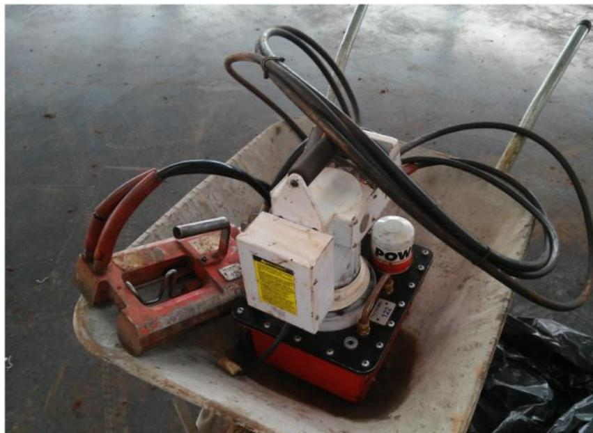
Figura 2.15: Macaco hidráulico em carrinho de mão para transporte
