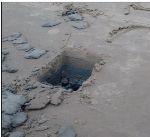
Figura 25 - Poço piezométrico realizado em frente a EMA no monitoramento de Junho-2015
