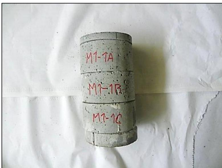
Figura 6.2 - Cortes efetuados nos CPs, tipo M1, em fatias de 50 mm. (Camacho, 2014).
