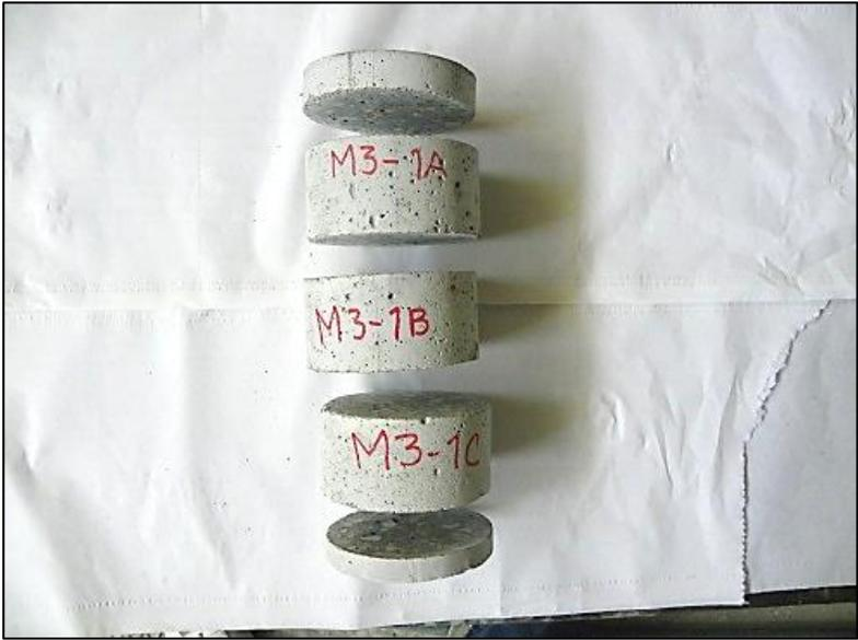
Figura 6.4 - Cortes efetuados nos CPs em fatias de 50 mm, tipo M3. (Camacho, 2014).
