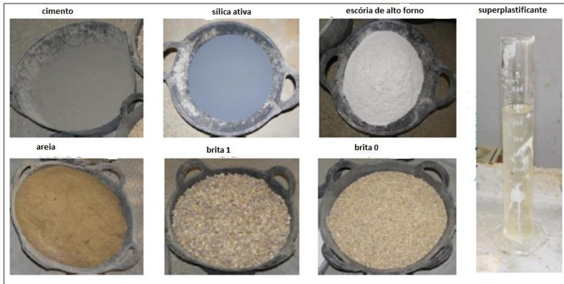
Figura 6.6 - Materiais empregados na confecção do concreto das amostras.
