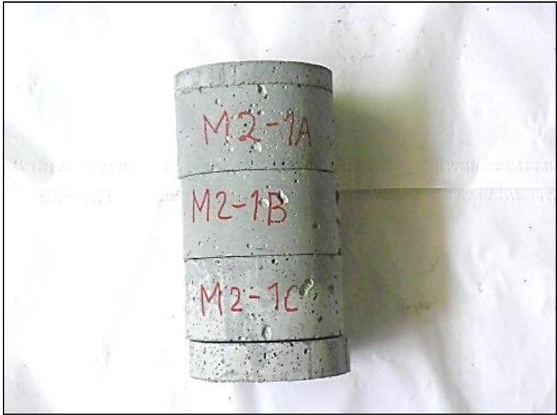
Figura 6.3 - Cortes efetuados nos CPs, tipo M2, em fatias de 50 mm. (Camacho, 2014).
