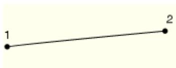
Figura 3.11 - Elemento de viga com 2 nós (B31).
