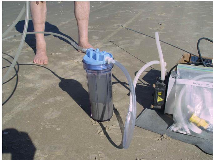
FIGURA 3.7 – Sistema de sucção e filtração de amostra
