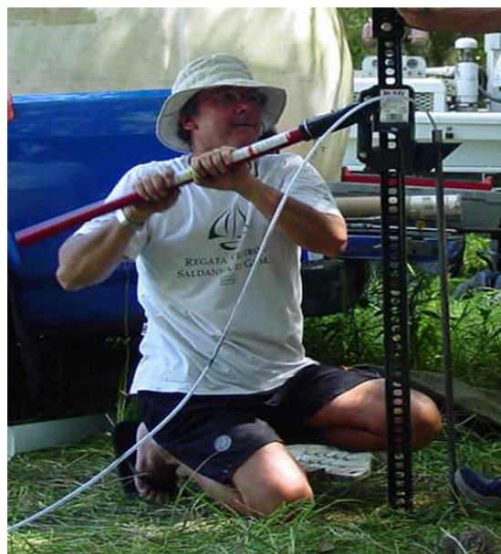
FIGURA 3.8 – Retirada do piezômetro
