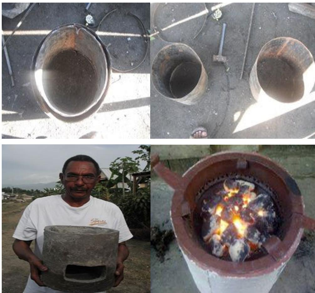
**Fig.14** Fabricação de fogões adaptados aos briquetes e seu funcionamento
