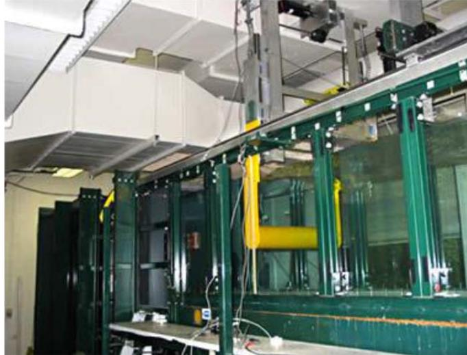
Figura 2.14 - Canal de testes com o dispositivo VIVACE instalado.
