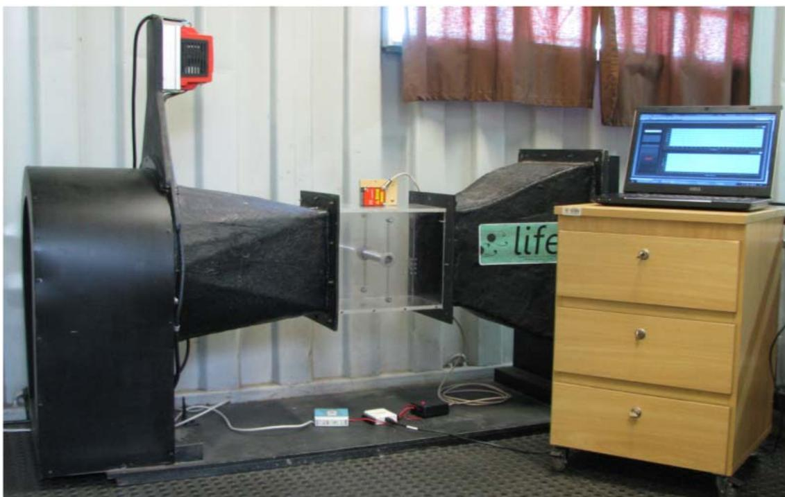
Figura 4.9 - Foto do túnel de vento com os equipamentos utilizados nos experimentos.
