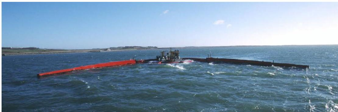
Figura 2.5 – Ilustração de um dispositivo do tipo *Wave Dragon* com estrutura flutuante e localização *offshore* (Kofoed et al., 2006).
