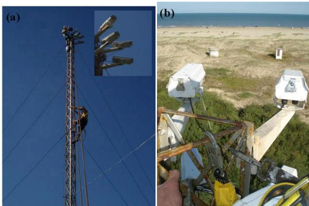
**Figura 3.2 – Sistema Argus instalado na praia do Cassino, câmeras posicionadas sobre a torre, destacando a região monitorada. (modificado de Guedes 2008).**
