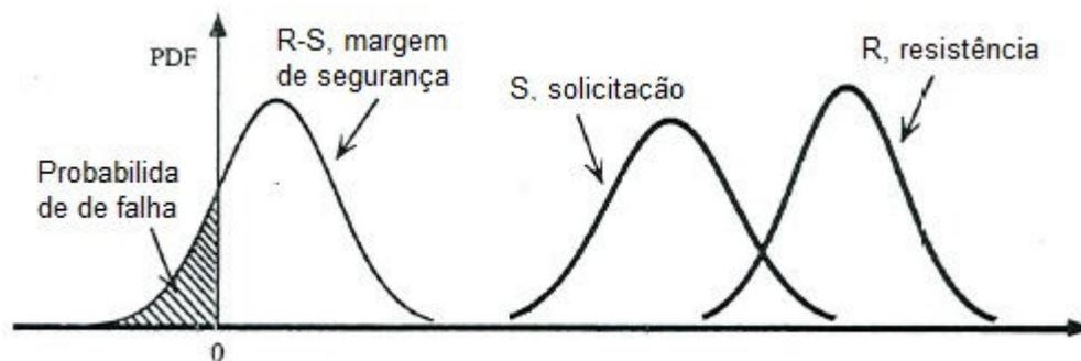
Figura 4.1 – Função densidade de probabilidade (PDF),  $R$ ,  $S$ ,  $R-S$ , Nowak e Collins (2000).
