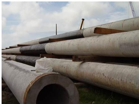
Figura 1.3 – Estacas pré-moldadas protendidas – Estocagem das estacas (TECON-RG).
