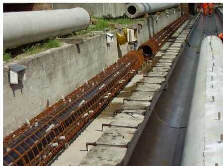
Figura 1.1 – Estacas pré-moldadas protendidas – Armadura passiva e forma das estacas (TECON-RG).
