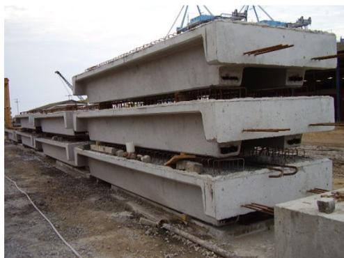
Figura 1.6 – Vigas pré-moldadas protendidas tipo PI – Estocagem de pré-moldados (TECON-RG).
