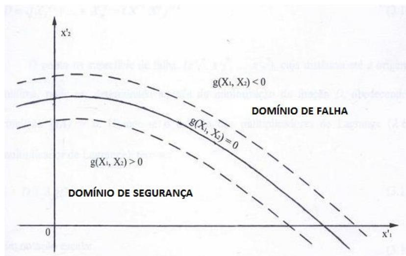
Figura 4.5 – Domínio de segurança e de falha no espaço das variáveis reduzidas, Ang e Tang (1990).
