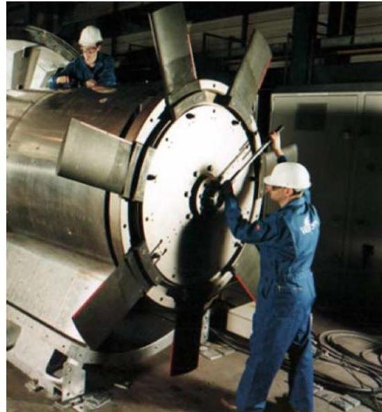
Figura 2.14 - Turbina da central de Limpet
