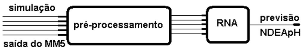
Figura 5.1 – Esquema básico do sistema de previsão de descargas elétricas.
